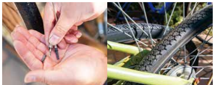
(左) 空気を入れるバルブ部分にある虫ゴムのゴム部分が破れていたり劣化していると、空気を入れても入らないという現象が起こるそう。今回はこの虫ゴムを交換。(右) 自転車の重みで潰れた地面と接したタイヤ部分は、動かしても元には戻りませんでした。これはタイヤの空気が抜けた状態で長期間放置していると起こってしまうそう。タイヤ交換はもちろんのこと、チューブとセットで交換が必要に。
