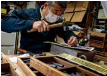
数百種類もある道具を使い分け、一枚の銅板から細かな装飾を作っていく。「これぞまさに職人技」と、その技術に目が釘付けになりました。
